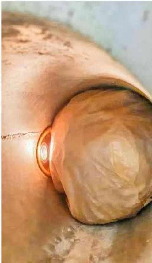
Das Messfenster bringt Licht ins Dunkel: Hier am Beispiel eines Sensoreinbaus in ein 6"-Rohr mit Gülleatrasse (Papierball). Der seitliche Einbau schützt vor Verschmutzungen und Luftblasen. Foto: Rainer Kock
