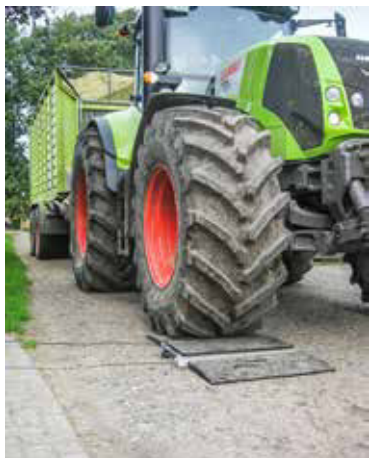
Bild 3: Ertragserfassung mit mobiler Achslastwaage im überbetrieblichen Einsatz. Die beiden Wiegeplatten werden mit gleichmäßiger Schrittgeschwindigkeit überfahren Foto: Buchholtz
