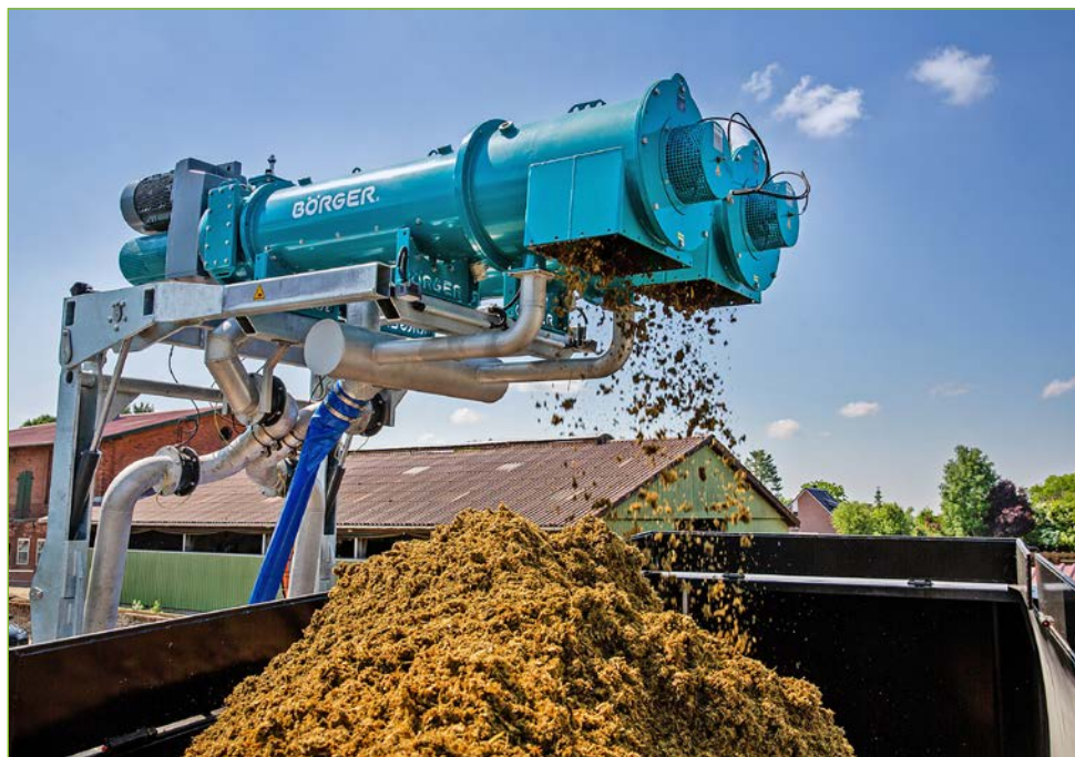
Mobile Gülleseparation (Eric Hamdorf)
