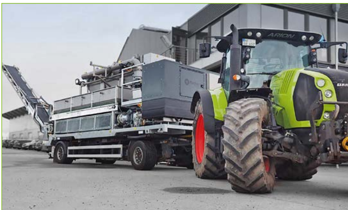
Die mobile Separationsanlage sollte während ihres Einsatzes auf Flächen stehen, die die Anforderungen nach AwSV erfüllen (Bahnsen Reh)
