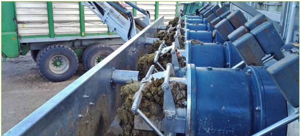
Pressschneckenseparatoren mit einem Durchsatz von bis zu 15 m 3 /h Gülle je Pressschnecke in Abhängigkeit vom Ausgangsmaterial (Peter Lausen)
