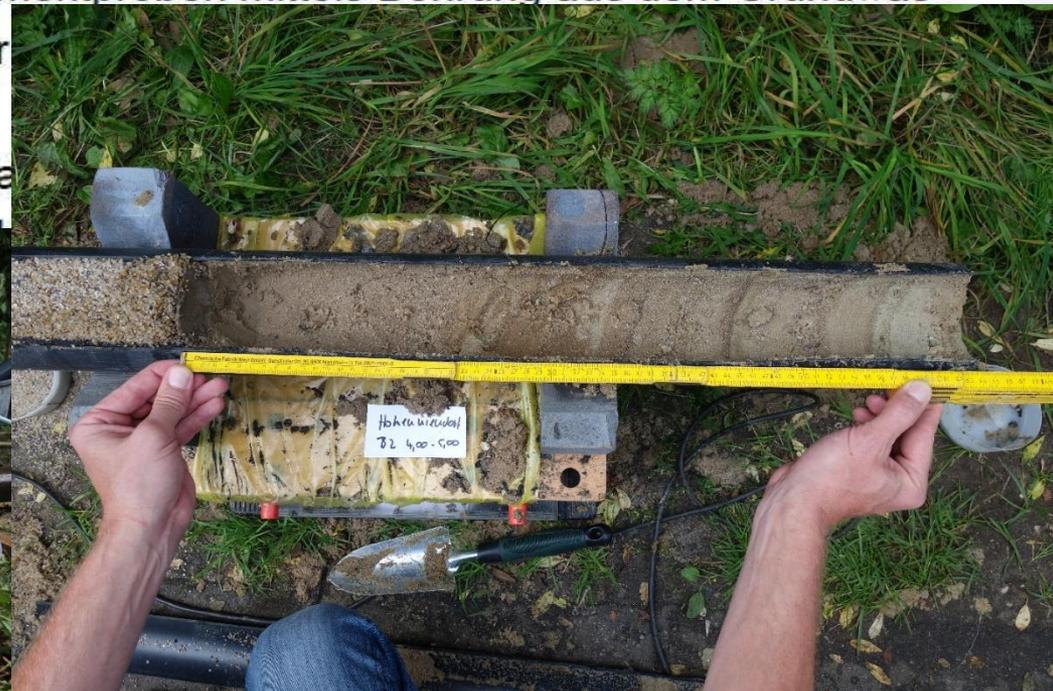
Messung des Denitrifikationspotenzials im Grundwasserleiter – Gewinnung der Proben
