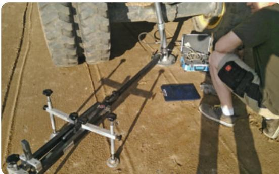
Abbildung 1: Beispiel eines statischen Lastplattendruckversuchs zur Feststellung der ausreichenden Verdichtung bzw. Tragfähigkeit
